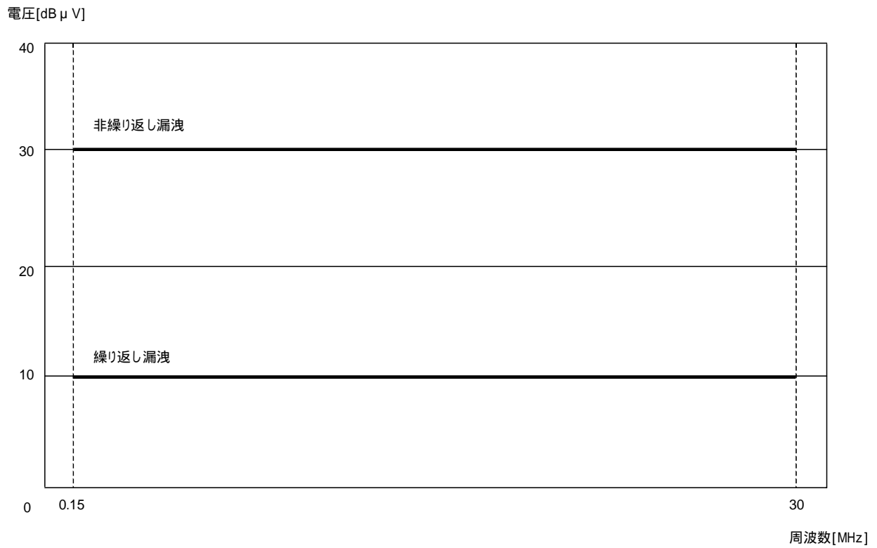
図 7-3 伝導漏洩試験の基準値(受信帯域幅 100[kHz])
